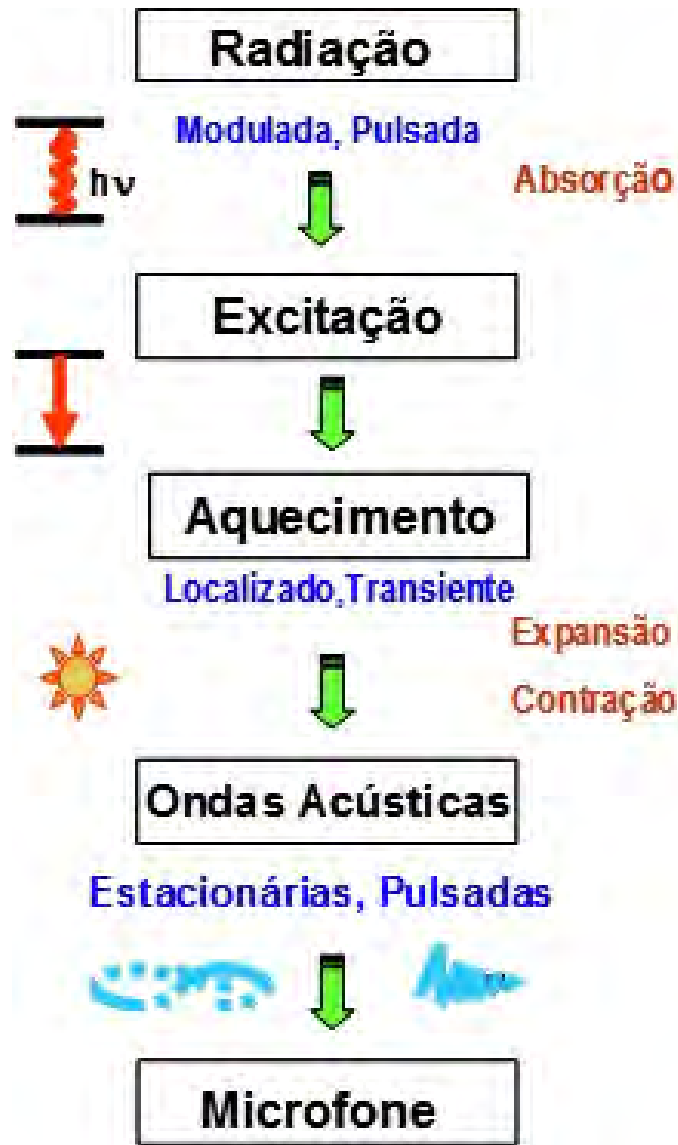
Figura 2.14: Esquema dos processos que ocorrem durante a geração do sinal fotoacústico (Miklos et al., 2001)
