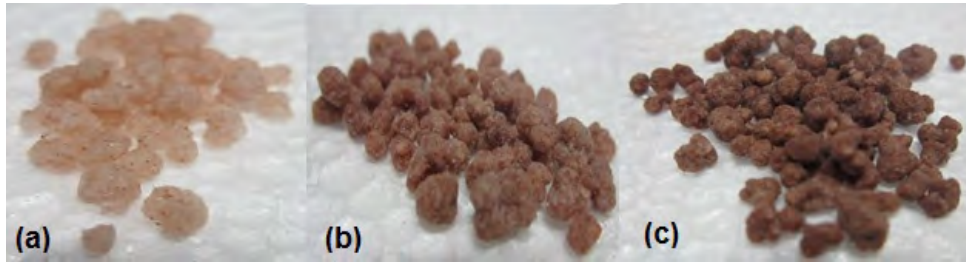
Figura 3.7: Granulados compostos por ureia e concentrado zeolítico em três teores diferentes: (a) 5%, (b) 20% e (c) 40%.
