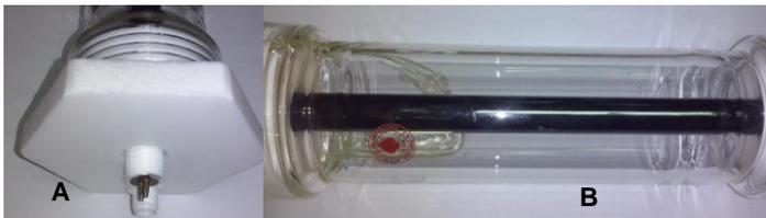
Figura 12: A-Tampa de teflon com orifícios; B- Reator de vidro com a lâmpada.
