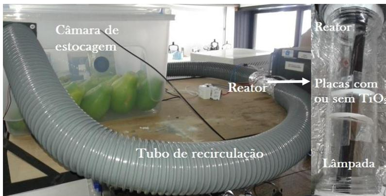
**Figura 15:** Sistema para degradação de etileno emitido por frutos (Destaque: reator tubular com as placas e lâmpada para irradiação).
