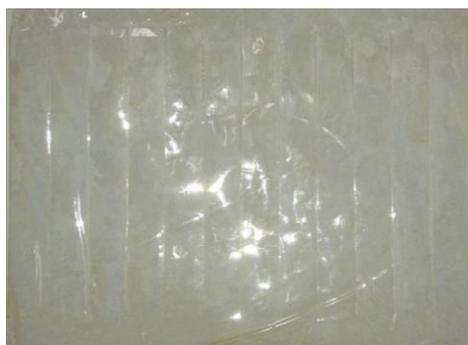
**Figura 10:** Foto do polipropileno impregnado com  $\text{TiO}_2$  sol-gel.
