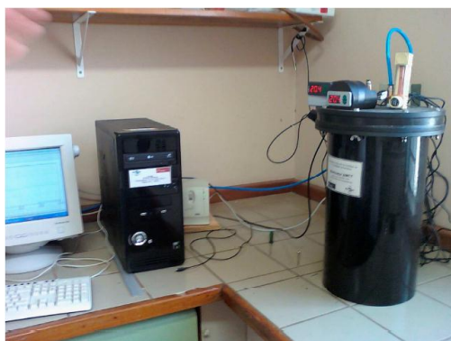
Figura 4.10: Biorreator aeróbio para simulação de processos de biodegradação de resíduos sólidos orgânicos (Foto Embrapa Solos)
