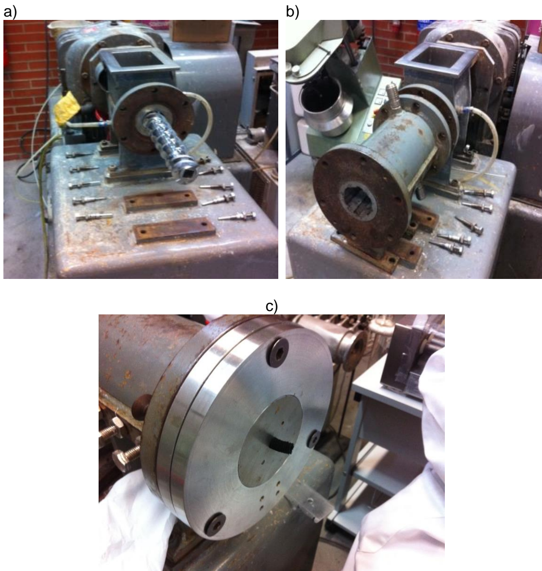
Figura 6. Dispositivo usado na preparação dos suportes e catalisadores por extrusão: a) detalhes do parafuso sem fim; b) detalhes da câmara de extrusão; c) detalhes do acessório onde se encaixa o molde desejado para fazer a extrusão
