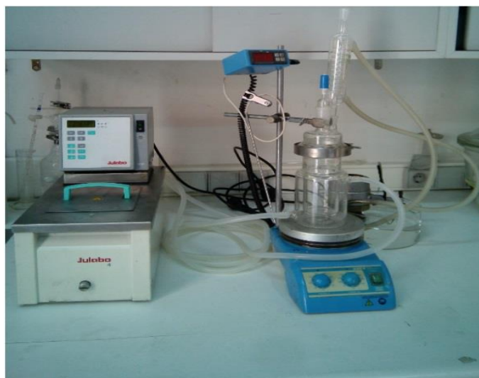
Figura 7. Sistema experimental utilizado para a reação de síntese de biodiesel do óleo de girassol e catalisadores heterogêneos.
