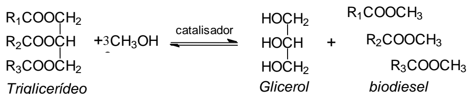
Esquema 1: Produção de ésteres metílicos e glicerol por transesterificação de triglicérides
