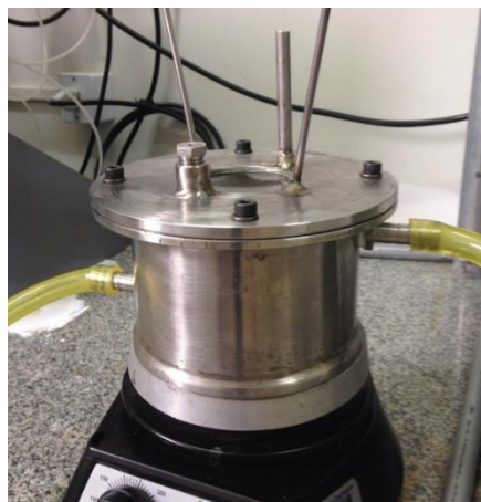
Figura 133: Destaque para o reator de aço inox utilizado nos testes fotocatalíticos
