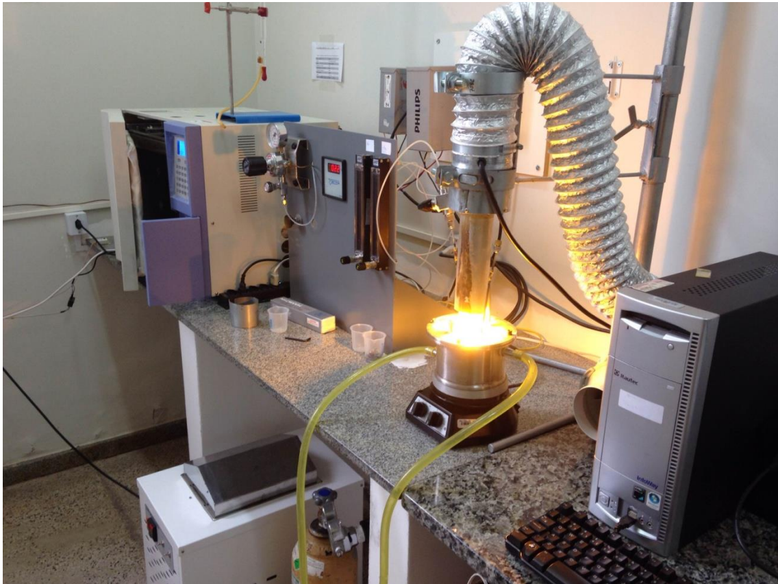
Figura 132: Foto da bancada onde está montado o experimento para geração de hidrogênio a partir da fotodecomposição da água
