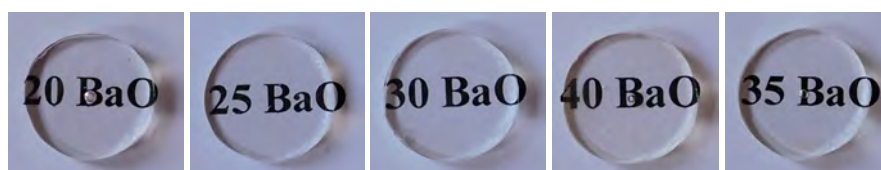
Figura 4.2 – Amostras do sistema \text{B}_2\text{O}_3:\text{BaO}:\text{Al}_2\text{O}_3 apresentando alta transparência com aproximadamente 2 mm de espessura variando a concentração de BaO.
