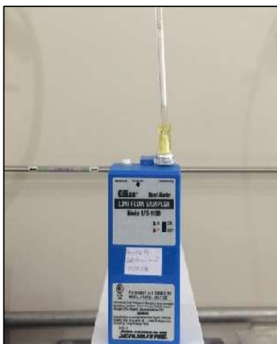
Figura 13. Aparatos utilizados para amostragens de COV: tubo de vidro preenchido com Tenax TA ® acoplado a uma bomba de sucção.
