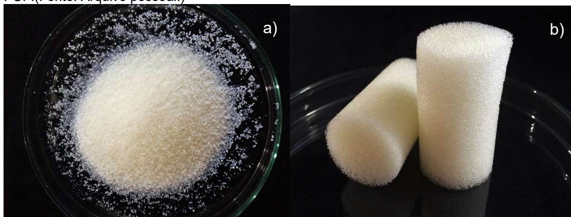
Figura 43. Materiais utilizados para amostragem de HPA na fase gasosa. Em a) XAD e em b) PUF. (Fonte: Arquivo pessoal.)
