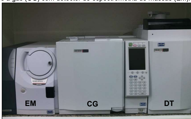
Figura 14. Equipamento utilizado para análise dos COV por dessorção térmica (DT) acoplado a um cromatógrafo a gás (CG) com detector de espectrometria de massas (EM).
