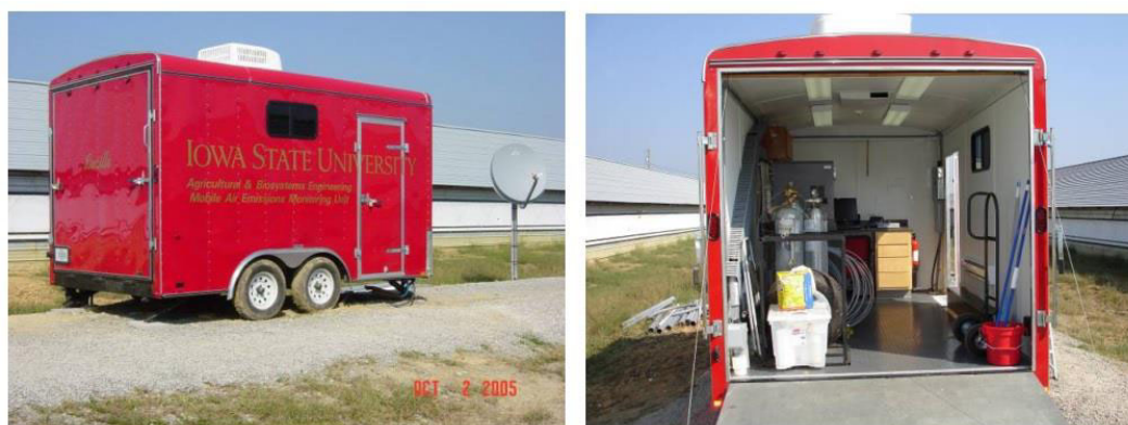
Figura 14: Unidade móvel de monitoramento de emissões do ar (MAEMU) (MOODY et al., 2008a)
