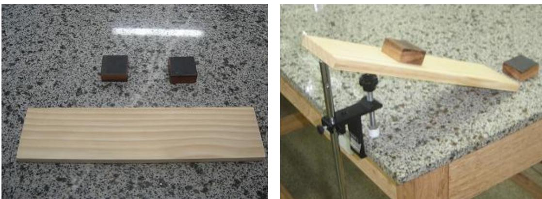
Figura 11 - Aparatos construídos para o estudo das forças de atrito.
