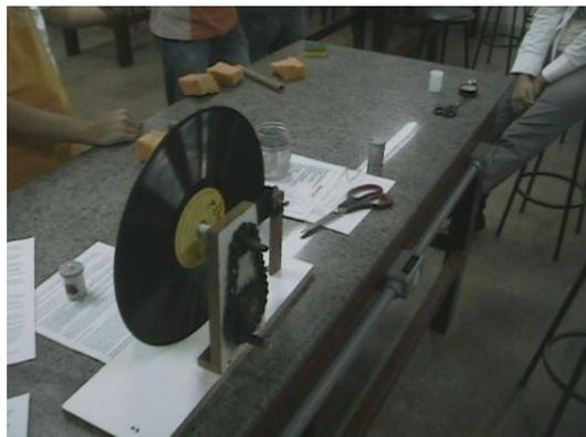
Figura 34 - Estudantes confeccionando capacitores cilíndricos e modelo de máquina eletrostática.
