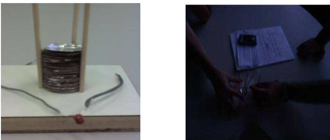
Figura 23 - Pilha montada e em funcionamento.
