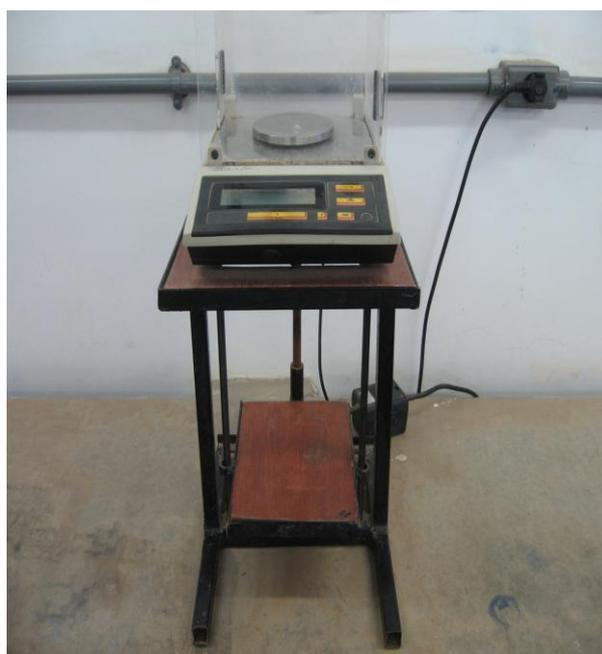
**Figura A13:** Balança hidrostática
