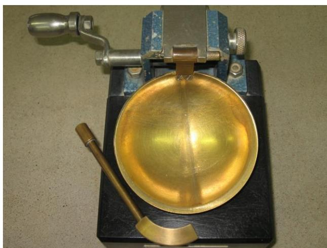
**Figura A8:** Aparelho de Casagrande e cinzel.
